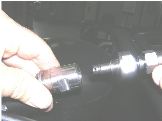
Extracción de la válvula de seguridad
